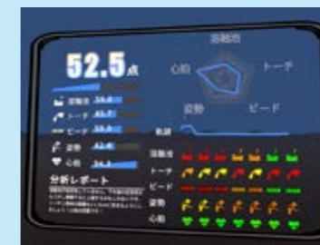
▶ 溶融池の安定度に加え、溶接トーチの動きや姿勢の良し悪しを分析・評価
